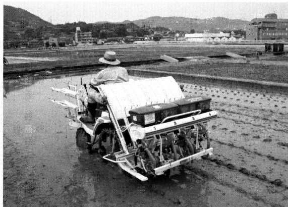
写真4. 田植え機に取り付けた側条施肥機を利用した条播(試験水田)
